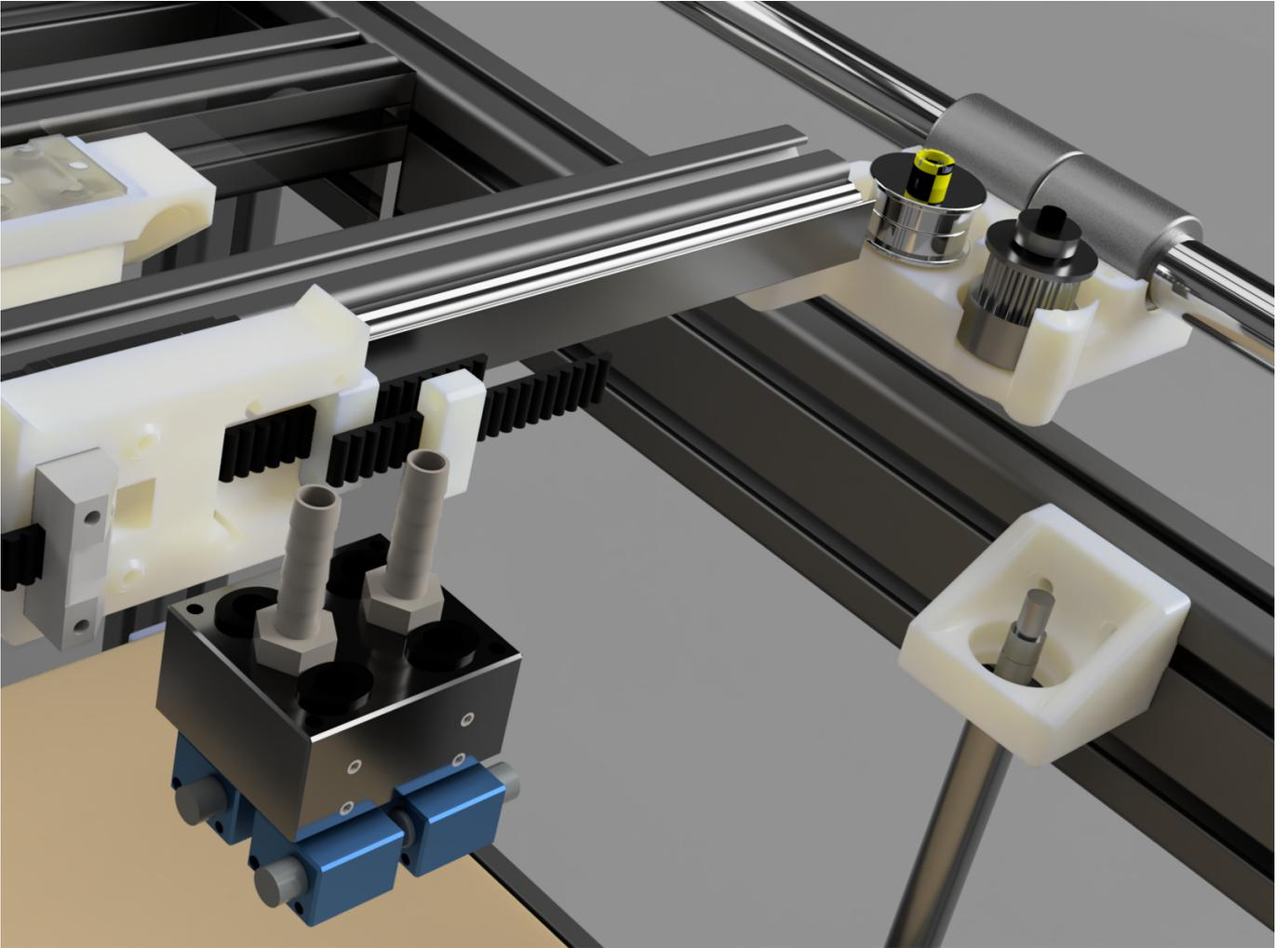
Druckkopf und Y Slider halb geöffnet.
