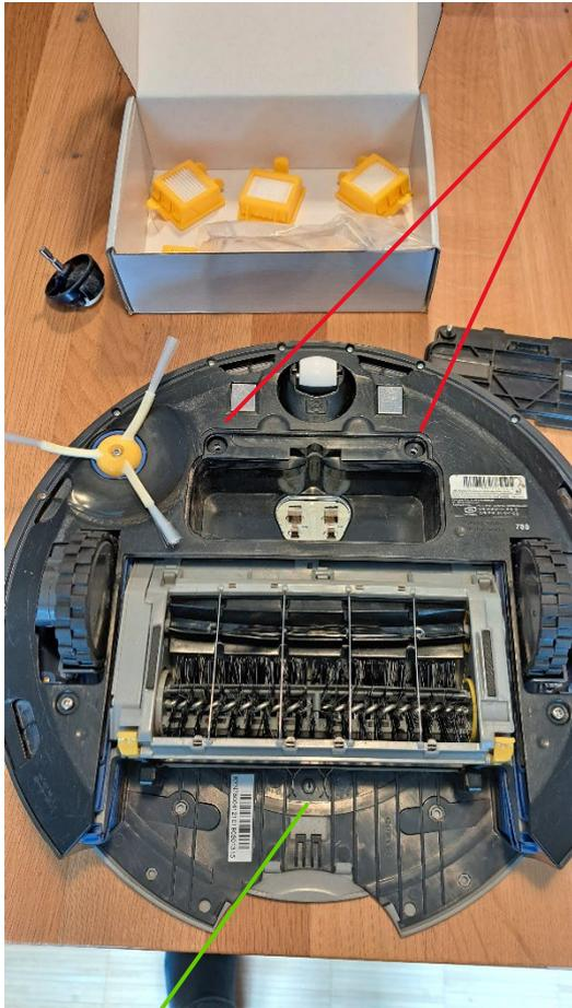
Zwei Schrauben lösen
